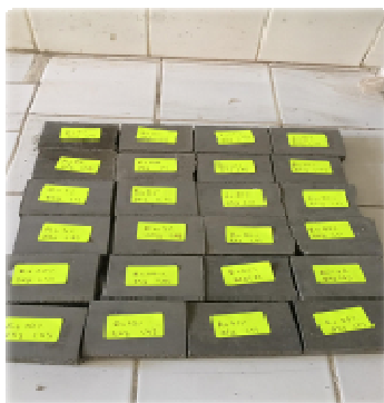
Fig1 : blocs de terre comprimée du sol gris après confection
