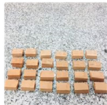
Fig2 : blocs de terre comprimée du sol rouge après confection
