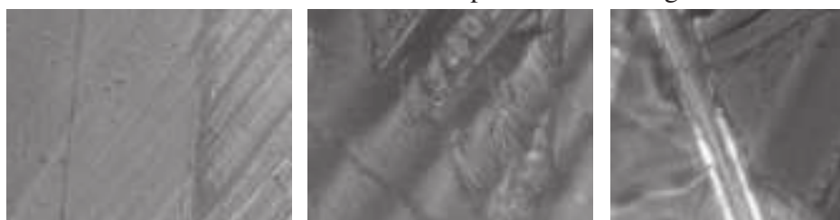
Figure.9. EXAMEN MICROSCOPIQUE DES FACIES DE RUPTURE (x500FOIS).
